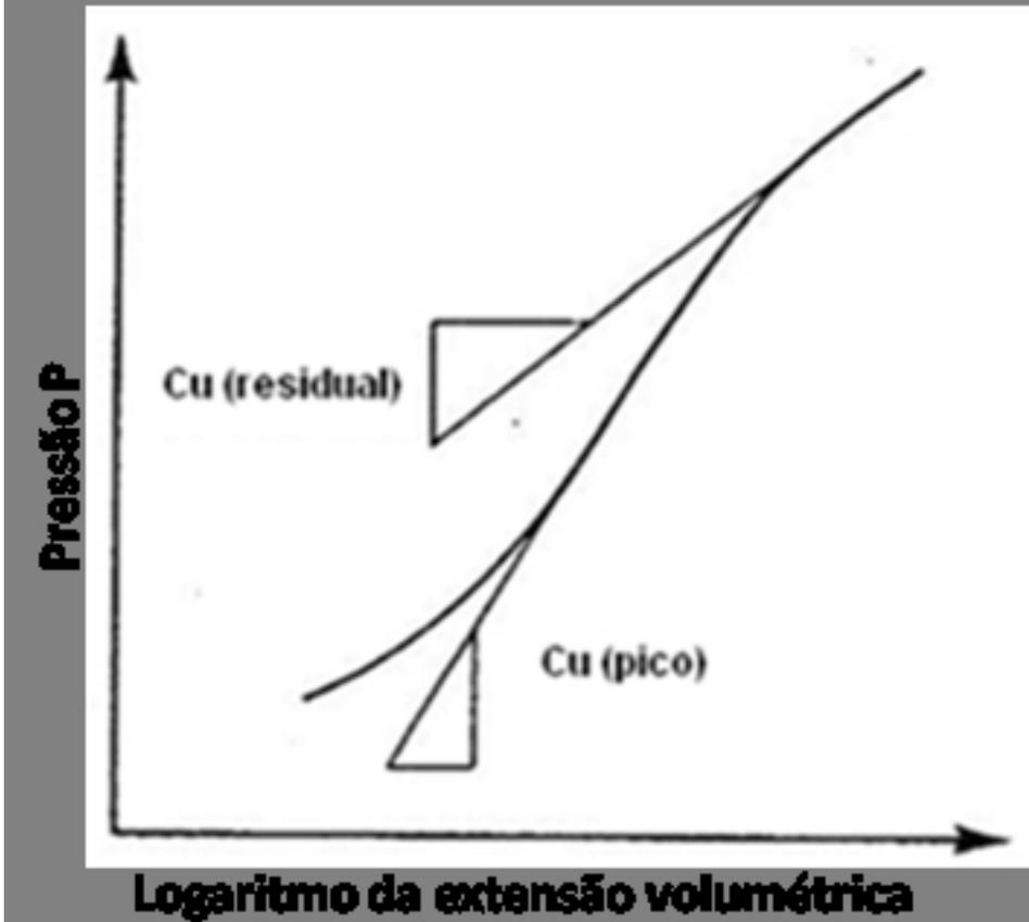
Figura 3. Relação entre a pressão e o logaritmo da extensão volumétrica em argilas (Mair e Wood, 1967) e curva de resistência em função da deformação (Mair e Wood, 1967) e curva de resistência em função da deformação (Mair e Wood, 1967)
