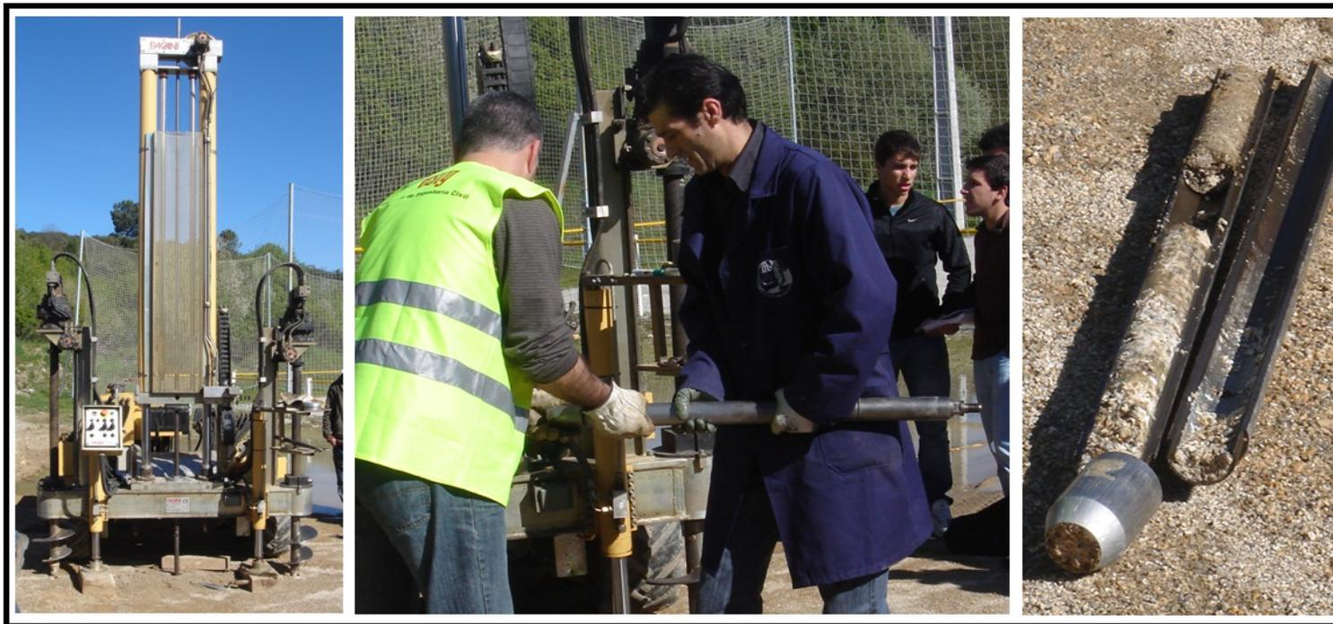
**Figura 2** - Cravação; Retirar o Amostrador; Retirar a amostra de solo.
