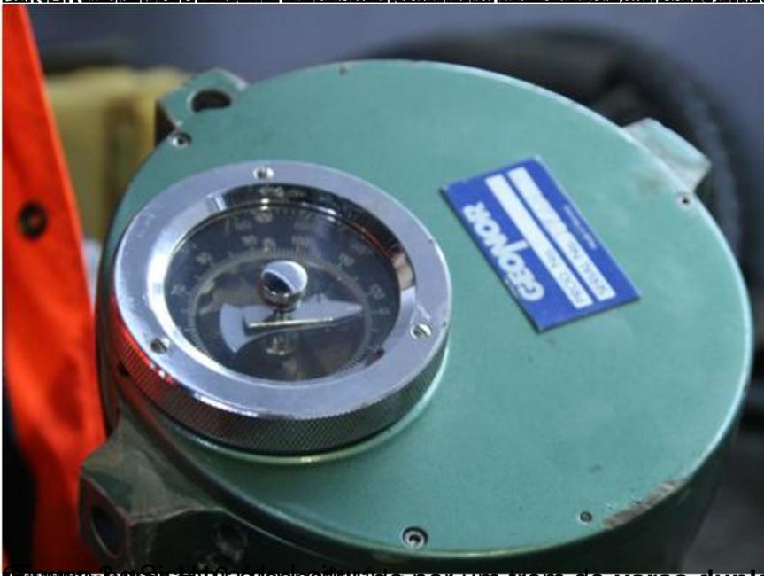
Equipamento utilizado para a medição de torque de varas duplas, acoplado um dispositivo protetor
