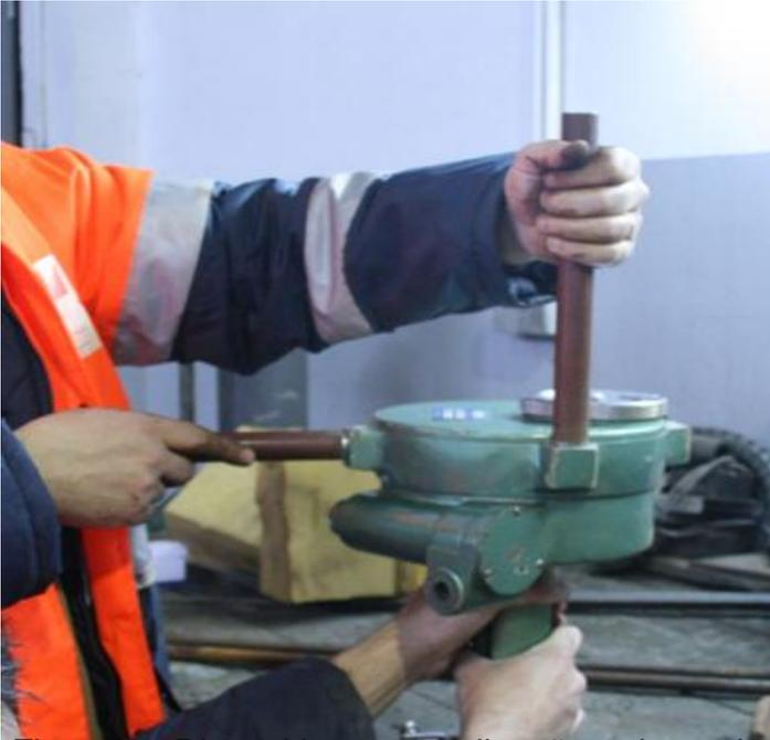
Figura 2. Dispositivo manual usado para determinação de forças de torção de um pedregulho
