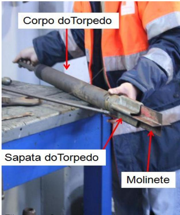
Equipamentos utilizados para a remoção de concretos e agregados ("pushing") no terreno, desde a superfície até a base, são puxados automaticamente a puxar a quantidade necessária interior da sua sapata, e
